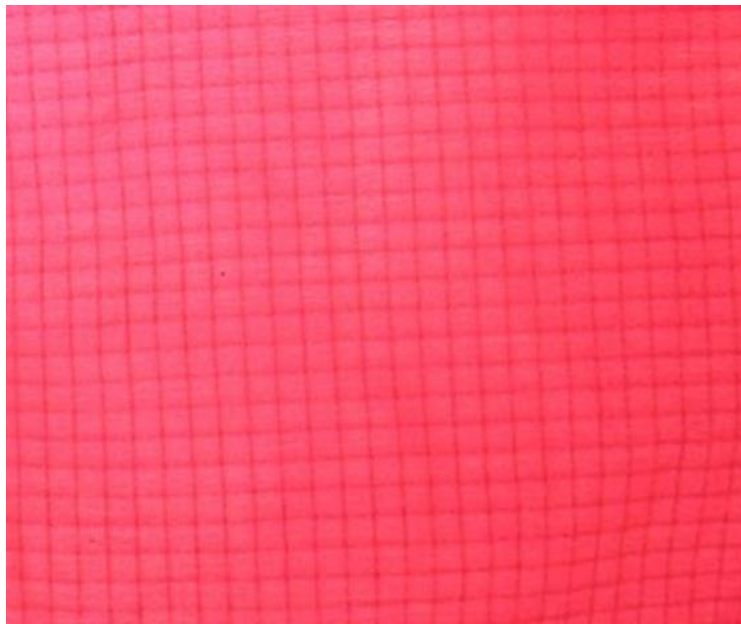
Figure C2 : Tissu Ripstop avec son aspect finement quadrillé. Une des directions s'appelle la trame, l'autre, perpendiculaire, s'appelle la chaîne.
