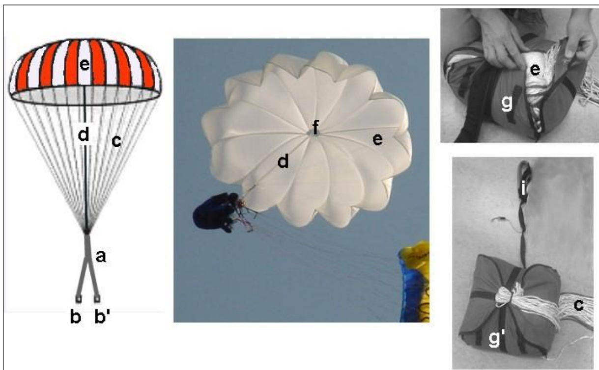
Figure C28 : Eléments du parachute de secours. a = élévateur (sangle) unique bifurquant symétriquement vers le bas, b = attaches avec gros maillons rapides trapézoïdes sur la sellette (en général sur les sangles d'épaules), d = suspente centrale, c = suspentes latérales plus fines, e = calotte, f = cheminée (ouverture) d'un secours « pull down apex », g = pod (container interne) ouvert, g' = pod fermé, i = sangle et poignée du pod permettant son extraction de la poche (container externe) du secours, fixée à la sellette.
