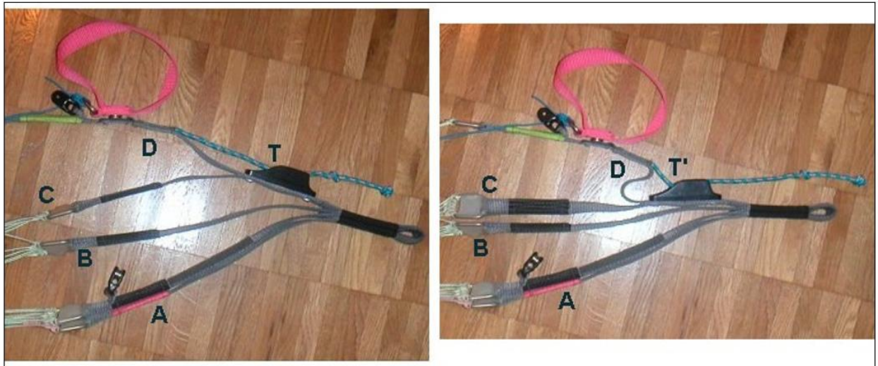
Figure C18 : Elévateur équipé de trimm-tab T détendu et T' tendu. Les groupes A à C ne sont pas touchés par T . Lorsque le trimm-tab est tendu, la partie inférieure de D se plisse et D se raccourcit globalement.
