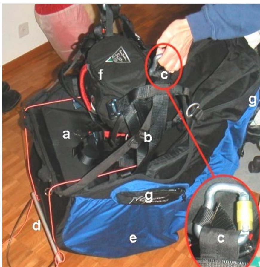
Figure C21 : Exemple de sellette avec airbag, a = partie inférieure rigide (planchette), b = sangles latérales convergeant vers le mousqueton (c). d = étrier de l'accélérateur, e = protection dorsale, f = parachute de secours (ici ventral), g = poches de rangement, latérales et dorsale.
