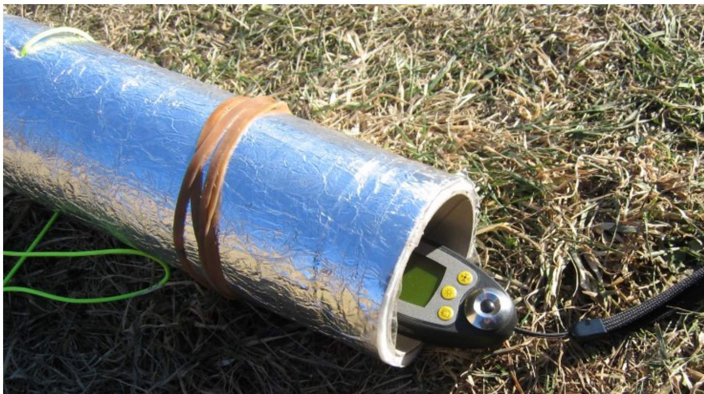
Figure 4 : le GEOS 11 sorti de son enveloppe protectrice.
