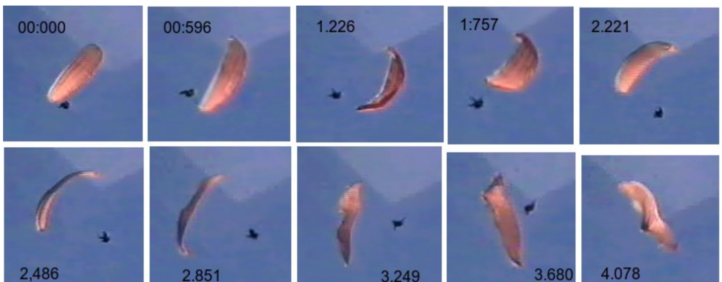
Figure 2: Décrochage. Extraits séquentiels d'une vidéo.
