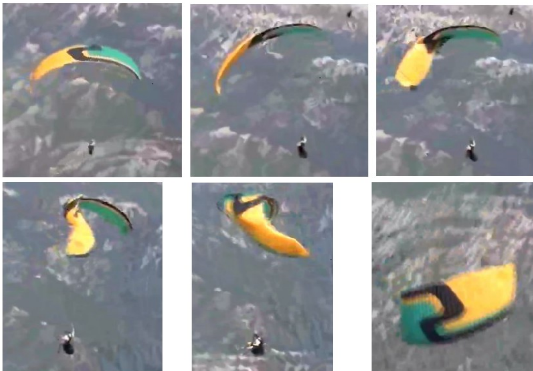
Figure 6: De gauche à droite et de haut en bas : Après une brusque ressource (thermique), abattée, fermeture latérale gauche puis autorotation gauche avec plongée vers le bas. Le pilote semble ne pas avoir réagi en contrant avec le frein droit dès l'amorce de fermeture gauche.
