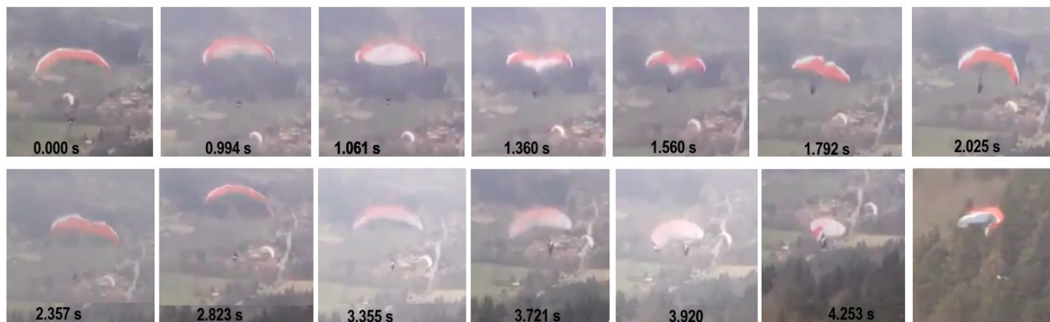
Figure 1 : Fermeture frontale massive. Extraits séquentiels d'une vidéo.
